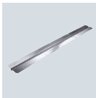
Uponor Siccus warmtegeleidingslamellen – stabiele aluminium lamellen met omega-groef voor een optimale warmteoverdracht van de systeemleiding. 2-voudig voorgestanst voor eenvoudig afkorten zonder gereedschap. Lamelafmeting 120 x 1180 mm.
