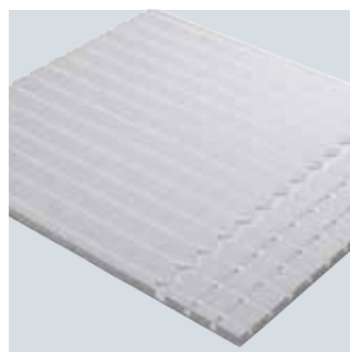
Uponor Siccus installatieplaat – installatieplaat van EPS met leidinggeleidekanalen voor de opname van Uponor Siccus warmtegeleidingslamellen. Installatieafstanden 15/22,5/30 cm.
