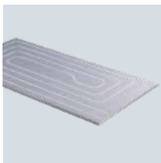
Uponor Renovis panelen – voor toepassing als individuele verwarmings- en koelpanelen, voor installatie op wanden of tegen plafonds, zowel voor renovatie als voor nieuwbouw. Montage op standaard 60/27 CD-profielen.
