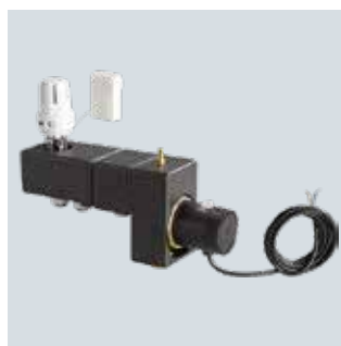
Uponor Fluvia T Push-12 pompgroep voor regulering van afzonderlijke ruimten en kleinere oppervlakteverwarmingen. Temperatuurregeling naar keuze met thermostaatknop met capillaire ruimtethermostaat of Uponor ruimtethermostaat (bekabeld of draadloos) met thermische aandrijving. Ideaal voor aansluiting van de vloerverwarming op een bestaand hoge-temperatuurnetwerk.
