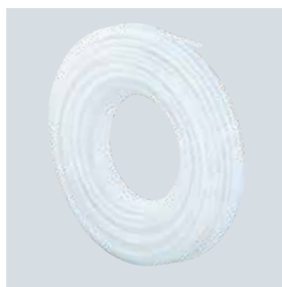
Uponor Comfort Pipe PLUS – PE-Xa leiding met zuurstofdiffusiedichte laag van EVOH een extra beschermlaag aan de buitenkant. Wit met twee blauwe strepen. Voldoet aan DIN EN ISO 15875, "Kunststofleidingssystemen voor warm- en koudwatersystemen, vernet polyethyleen", zuurstofdiffusiedicht volgens DIN 4726.
