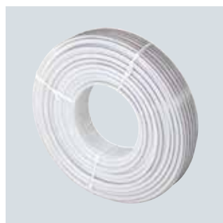
Uponor Comfort Pipe PLUS – PE-Xa leiding met zuurstofdiffusiedichte laag van EVOH en een extra beschermilaag aan de buitenkant. Wit met twee blauwe strepen. Voldoet aan DIN EN ISO 15875, "Kunststofleidingssystemen voor warm- en koudwatersystemen, vernet polyethyleen", zuurstofdiffusiedicht volgens DIN 4726.
