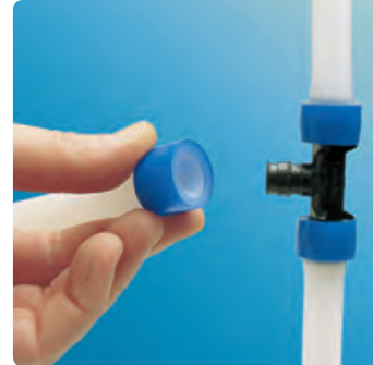
Plaatsen: de ring iets over het leidingeinde laten uitsteken (maximaal 1 mm).
