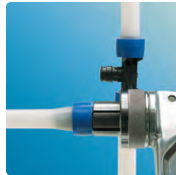
Expanderen: expansiekop erin steken en verwijderen. Proces zo vaak herhalen, totdat de aanslag is bereikt. Bij elke procedure het gereedschap circa ¼ van de omvang verdraaien.
