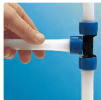
Monteren: leiding tot aan de aanslag op de fittingnippel schuiven, even vasthouden, totdat de leiding gekrompen is.
