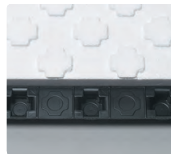
Het speciale profiel aan de onderzijde van de plaat en de dubbele schuiming van de geïntegreerde warmte-isolatie reduceren het contactgeluid in combinatie met het Uponor Tecto element ND 30-2 met 28 dB.
