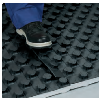
Installeren en verbinden kunnen zonder hulp nauwkeurig worden afgehandeld: de elementen eenvoudig met de voet bij de folieoverlapping samenvoegen - klaar. Dit spaart tijd en kosten.
